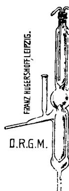
Die Pumpe nach dem Hauptpatent arbeitet etwas langsam. Um dies zu vermeiden, wird das gebogene Fallrohr des Hauptpatentes durch ein gerades jedoch kurzes Rohr ersetzt. Zu diesem Zweck ist ein elektrischer Tropfenbildner vorgesehen, welcher den Abschluß eines Fallrohrs ohne Biegungen schon in seinem oberen Ende bewerkstelligt, so daß die Pumpe ihre verkürzte Form erhalten kann, ohne an Schnelligkeit zu verlieren. Durch Anbringung des Tropfenbildners wird die Geschwindigkeit des
