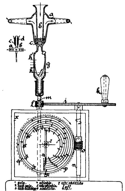
2. Luft- und Gasprüfer nach Anspruch 1, gekennzeichnet durch eine der Turbine a proportional sich drehende Scheibe p mit den verschiedenen Prüfungsverhältnissen entsprechenden Prüfungs- skalen I, II, III usw.
